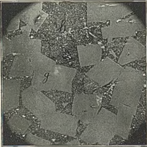
Abbildung 16. Schlacke G 2 2. Grundmasse h zeigt eutektischen Aufbau.
