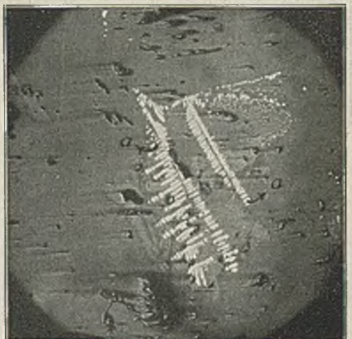
Abbildung 31. Schlacke F 1 (grau). Nicht geätzt.
