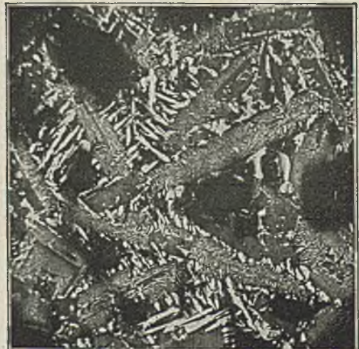
Abbildung 19. Schlacke R 2. Ternäres Eutektikum.
