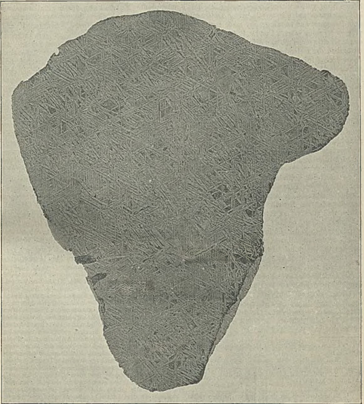
Abbildung 14. Gefüge der Eisenmasse von Elbogen in Böhmen mit Widmannstättenschen Figuren; nach einem Naturelstdruck (1813).
