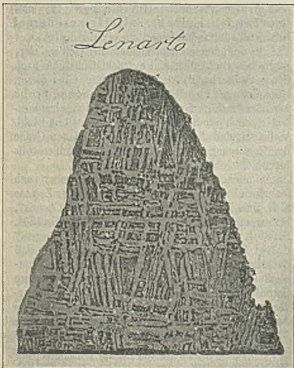
Abbildung 12. Gefüge des Meteoriteisens von Lénarto nach C. v. Schreibers (um 1810).
