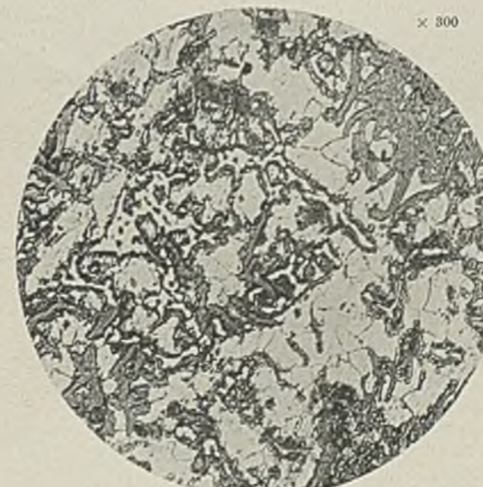
Abbildung 53. Nr. 1. 15 st bei 900° geglüht. Geätzt. Innen.
