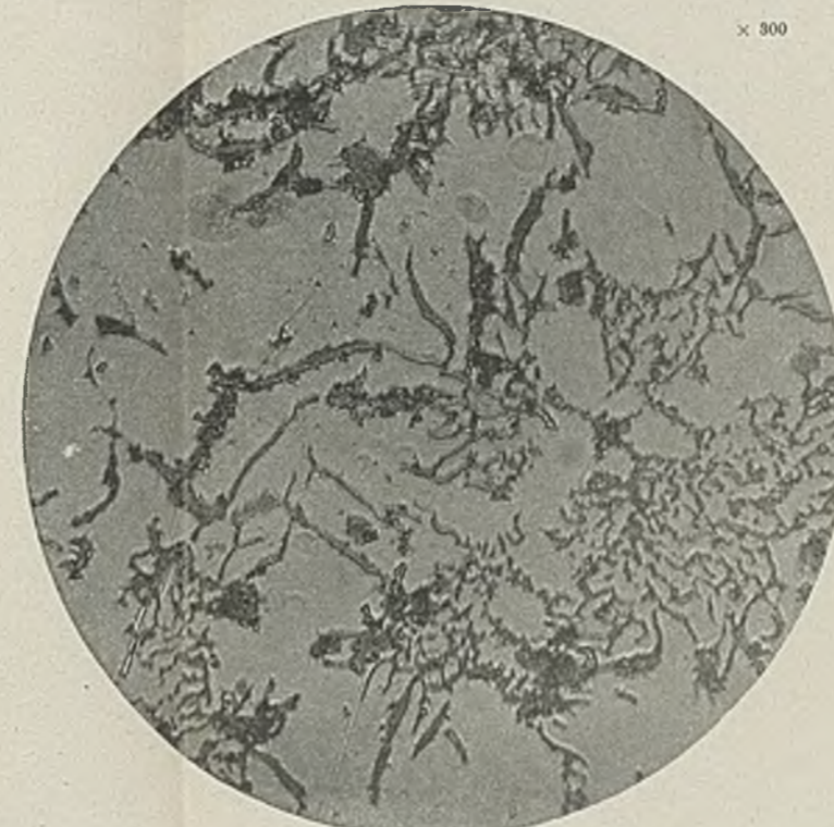
Abbildung 51. Nr. 1. 15 st bei 900° geglüht. Ungeätzt. Innen.
