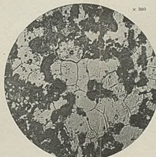
Abbildung 52. Nr. 1. 15 st bei 900° geglüht. Geätzt. Außen.
