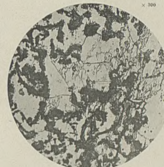
Abbildung 50. Nr. 2. 15 st bei 900° geglüht. Geätzt. Außen.
