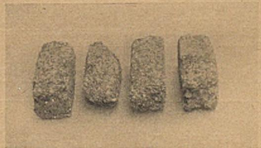
Bild 4c Vom Frost zerstörter Kunststein
