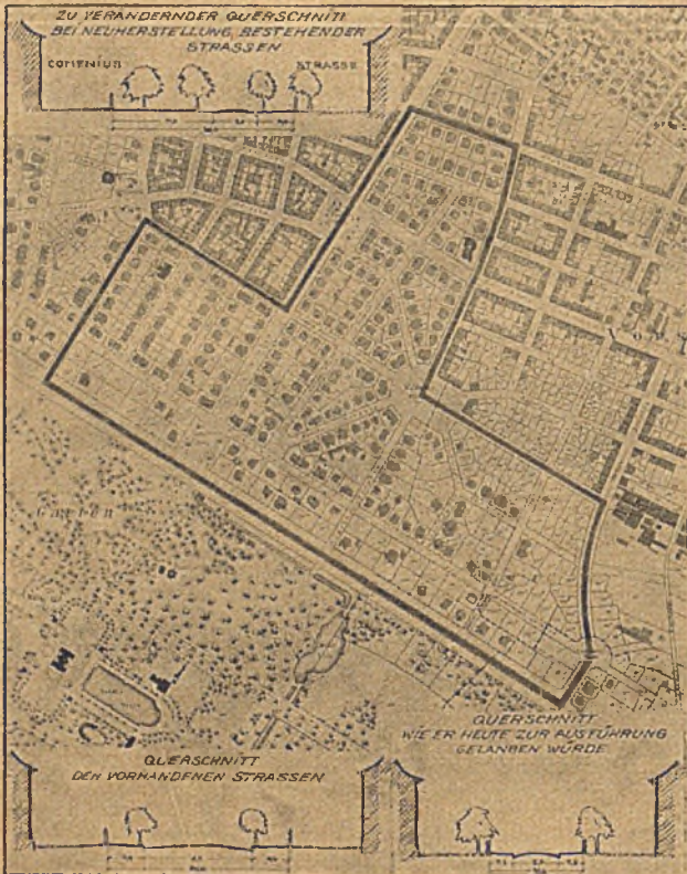
Abb. 8. Beispiel der Erschließung eines Geländes mit unmäßig breiten Straßen nach älterem Bepbauungsplan.
