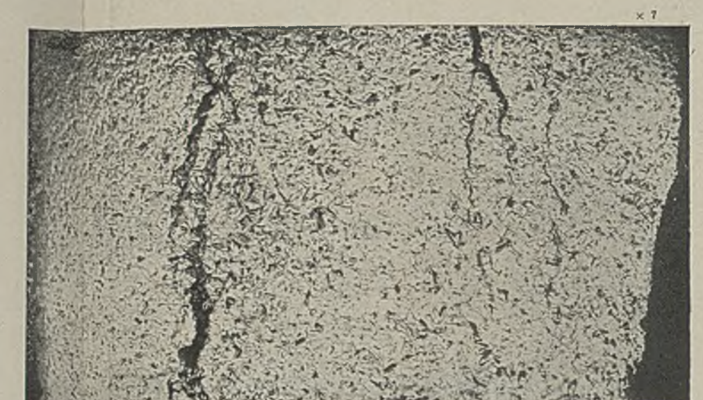
Abbildung 10. Ungeätzt. Stark angegriffener Teil. Graphitverteilung, Risse.
