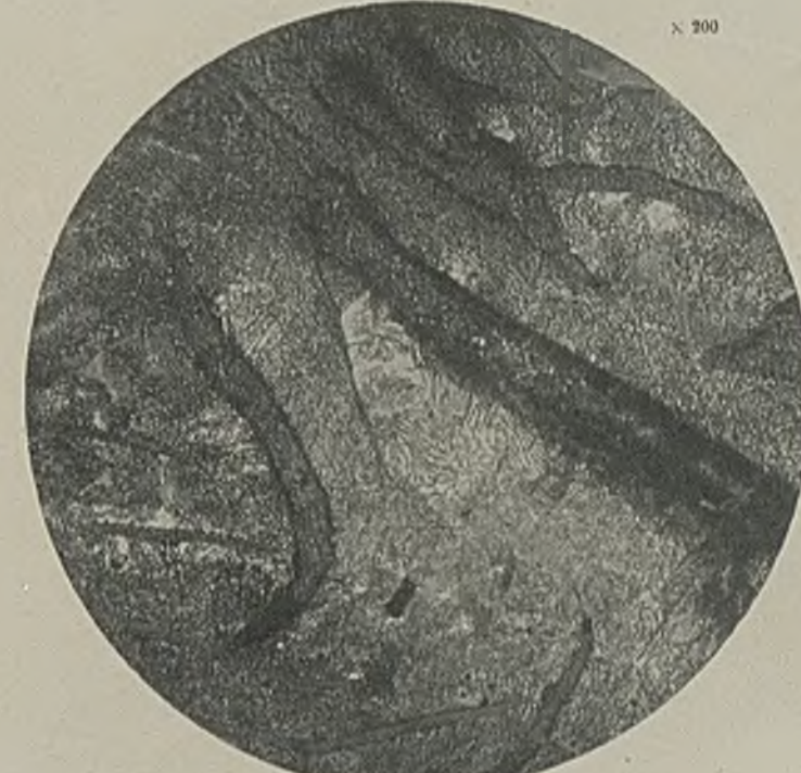
Abbildung 17. Geätzt. Stark angegriffener Teil. Mitte. Die Graphitlamellen sind durch die Säure verbreitert worden.
