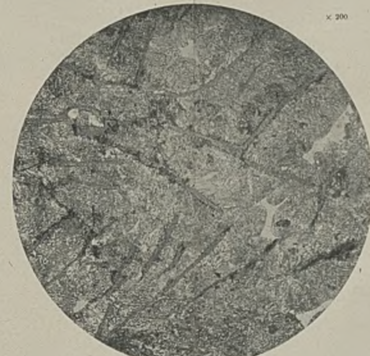
Abbildung 13. Geätzt. Gesunder Teil. Außen.
