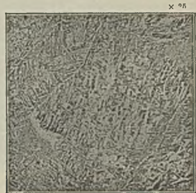
Abbildung 6. Gefügeaussehen eines ungeglühten Stahlgusses.
