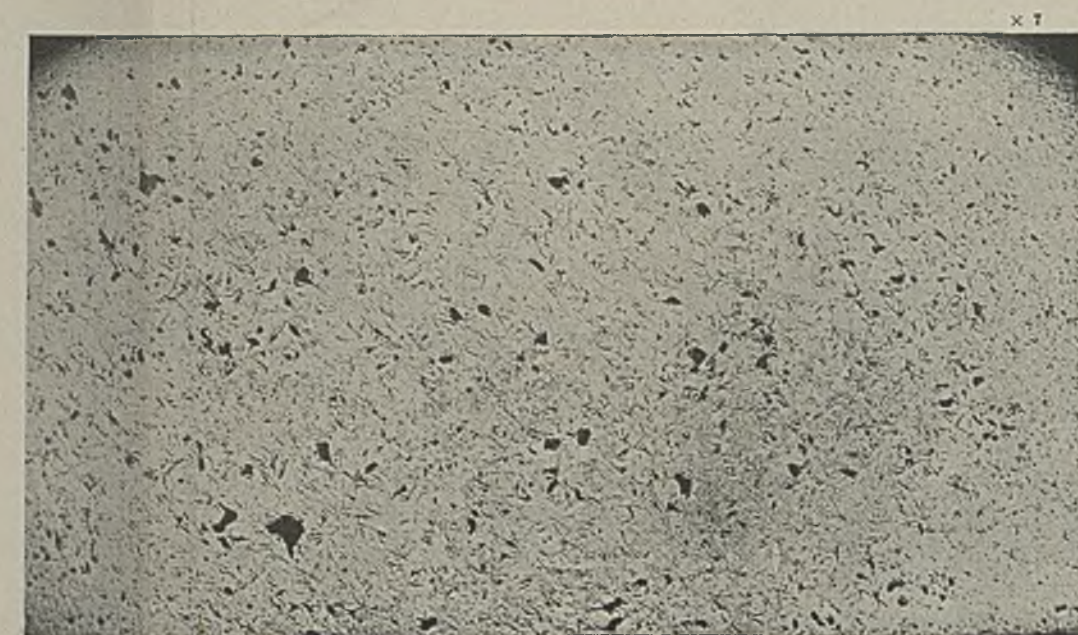
Abbildung 9. Ungeätzt. Gesunder Teil. Graphitverteilung.
