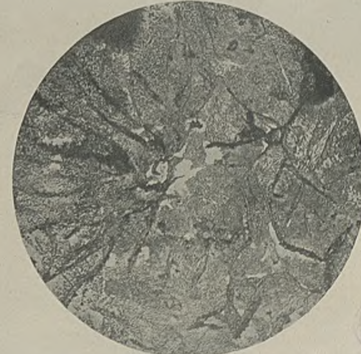
Abbildung 18. Geätzt. Stark angegriffener Teil. Innen.
