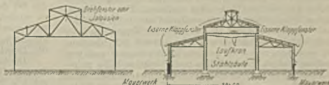
Abbildung 1. Querschnitt einer Gießerei für Kleinguß.
