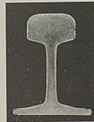
Abbildung 8. Folgen ungünstig gelegener Randblasen in einem Stahlblock: Beim Auswalzen reißen die unverschweißten Gasblasen auf und geben eine unsaubere Oberfläche an der rechten Seitenfläche des Kopfes.
