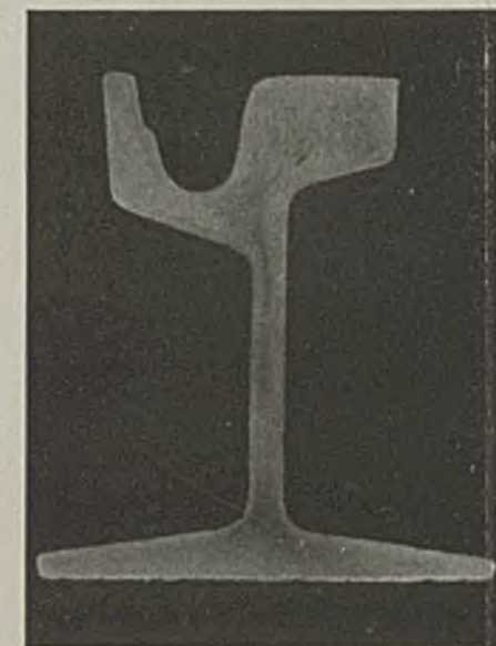
Abbildung 41. Cöln Schiene, nicht riffelig. Querschnitt nach der Kupferammoniumchlorid-Ätzung.
