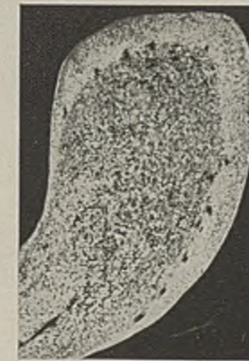
Abbildung 14. Aachener Schiene, Teilbild von Abbildung 13, um zu zeigen, daß der Schwefel in Form kleiner Sulfideinschlüsse im Stahl enthalten ist.
