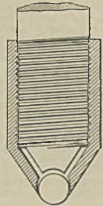
Abbildung 2. Einbau der Stahlkugel.
