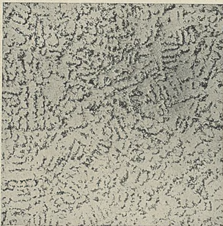
Abbildung 80. Manganreiche Qualität, gegläht (Normalstab).
