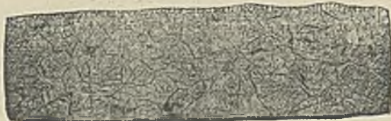
Abbildung 28. Dasselbe Eisen wie Abb. 27, aber zementiert. Abbildung 25—28. Naturselbstdrucke nach Sorby 1887.
