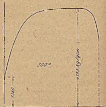
Abbildung 3. ZerreiBdiagramm von weichem Flußeisen bei 300° (nach v. Bach).
