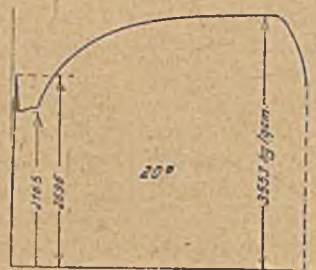
Abbildung 2. ZerreiBdiagramm von weichem Flußeisen bei 20° (nach v. Bach).
