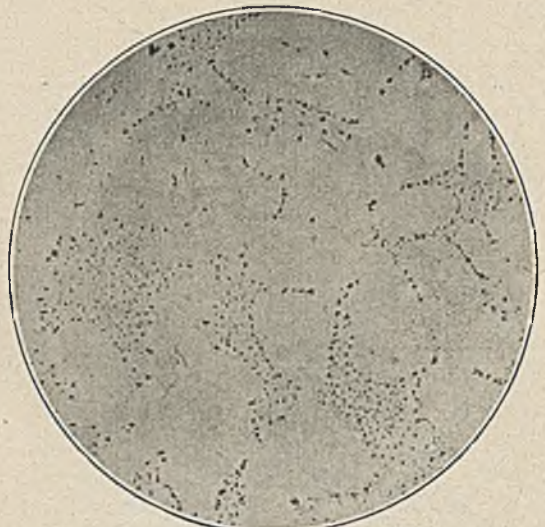
Abbildung 43. Sauerstoffhaltiges Eisen, mit Mangan desoxydiert. \times 50
