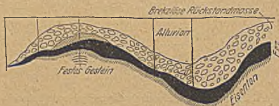
Abbildung 3. Profil durch eine der Eisenerzlagertätten von Alapajewsk.
