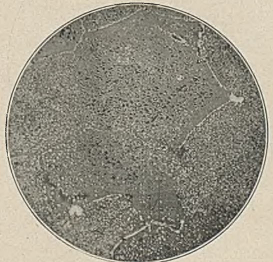
Abbildung 23. Wie Abb. 21, jedoch 20 min bei 950^{\circ} reduziert. \times 150
