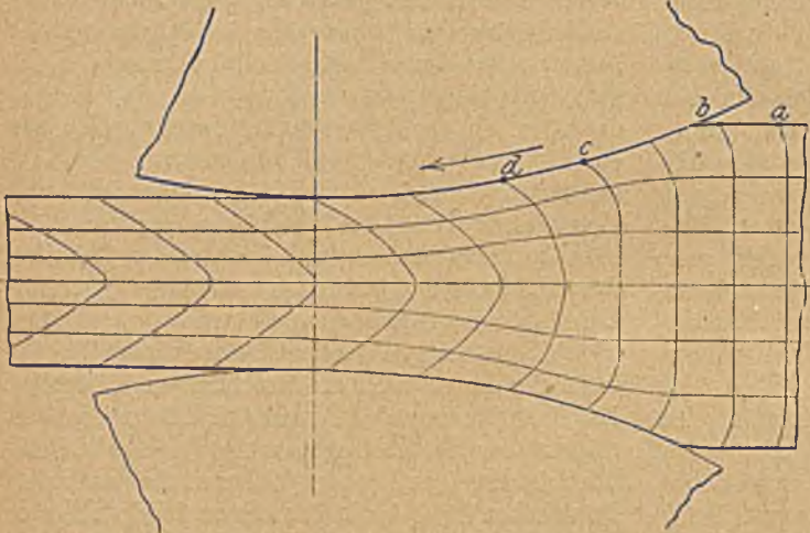
Abbildung 1. Von Kick ermittelte Verschiebungsbilder beim Walzen von Tonkörpern.
