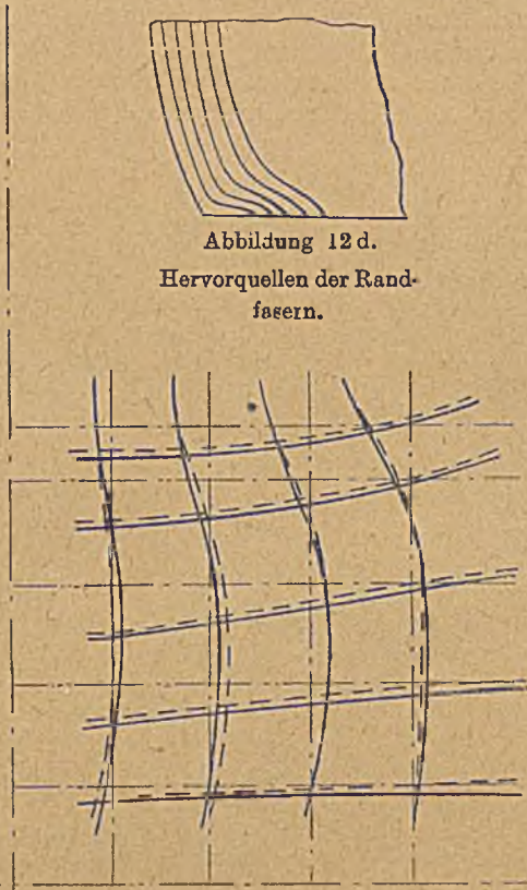
Abbildung 12 e. Links: Mittellinien der Probekörperbohrungen vor dem Pressen. Rechts: Mittellinien der Probekörperbohrungen nach dem Pressen. Ausgezogene Linien: Körper I. Gestrichelte Linien: Körper II. Strichpunktlierte Linien: Theoretische Form bei störangsfreier Verdrängung.
