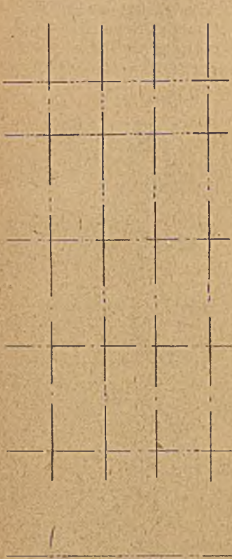
Abbildung 12 e. Links: Mittellinien der Probekörperbohrungen vor dem Pressen. Rechts: Mittellinien der Probekörperbohrungen nach dem Pressen. Ausgezogene Linien: Körper I. Gestrichelte Linien: Körper II. Strichpunktlierte Linien: Theoretische Form bei störangsfreier Verdrängung.
