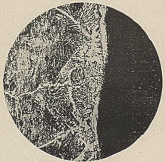
Abbildung 5. In Stickstoff geblühtes Material.
