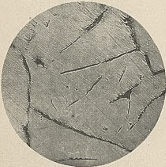
Abbildung 2. Roheisen, poliert und ungeätzt, vor dem Versuch.
