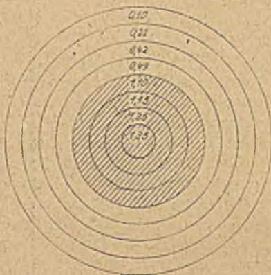
Abbildung 1. Verteilung des Kohlenstoffgehaltes im Gesamtquerschnitt nach dem Glühen (nach Arnold und M'William).
