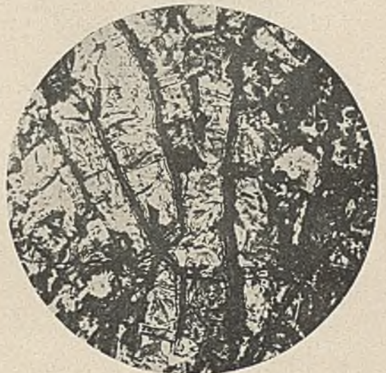
Abbildung 3. Roheisen, poliert und ungeätzt, nach ein-stündigem Glühen im Wasserstoffstrom.
