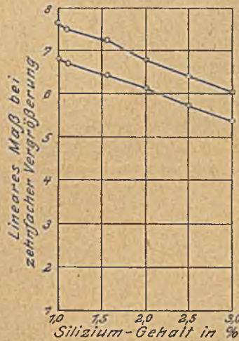
Abbildung 5, Abnahme der Zugspannungen mit steigendem Siliziumgehalt; Versuchskörper grün gegossen.
