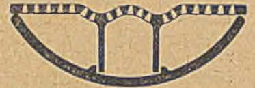
Abbildung 6, Evaporatorfeuerung, Querschnitt durch den Rost.
