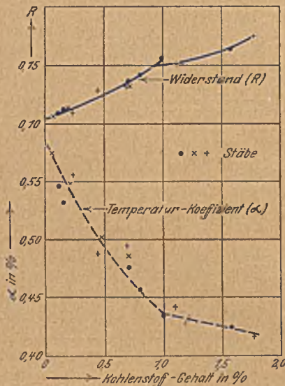
Abbildung 12. Widerstand und Temperaturkoeffizient des Widerstandes der Kohlenstoff-Legierungen. Nach langsamem Abkühlen von 930 °.
