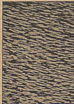
Nach dem 1. Auswalzen (Streckung 5:1).
