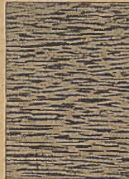
Nach dem 2. Auswalzen (Streckung 80:1).
