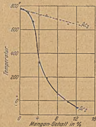
Abbildung 29. Magnetische Umwandlungspunkte der Mangan-Legierungen.
