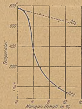
Abbildung 29. Magnetische Umwandlungspunkte der Mangan-Legierungen.
