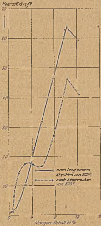
Abbildung 30. Koerzitivkraft der Mangan-Legierungen.
