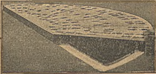
Abbildung 9. Form eines Plandrehbank-Scheibenteiles mit teilweise eingelegten Kernen.
