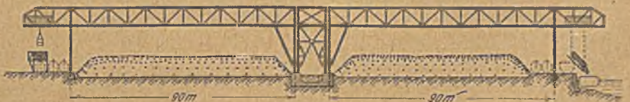
Abbildung 8. Erzkipperanlage mit mehreren zusammenarbeitenden Verladebrücken.
