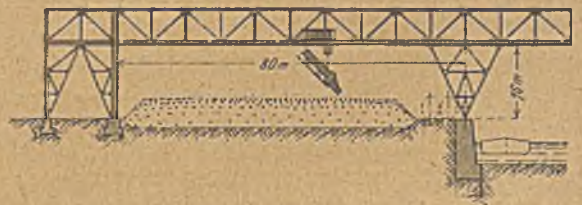
Abbildung 7. Erzkipperanlage mit Auswechslungsturm für die Laufkatze.
