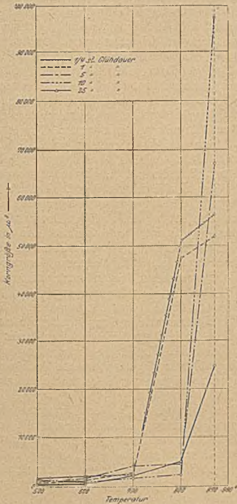
Abbildung 5. Rekristallisation der um 50% der ursprünglichen Höhe gestauchten Proben.
