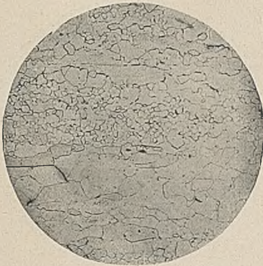
Abbildung 7. Probe der Druckstufe IV, bei 500° 1 Std. geglüht. × 100
