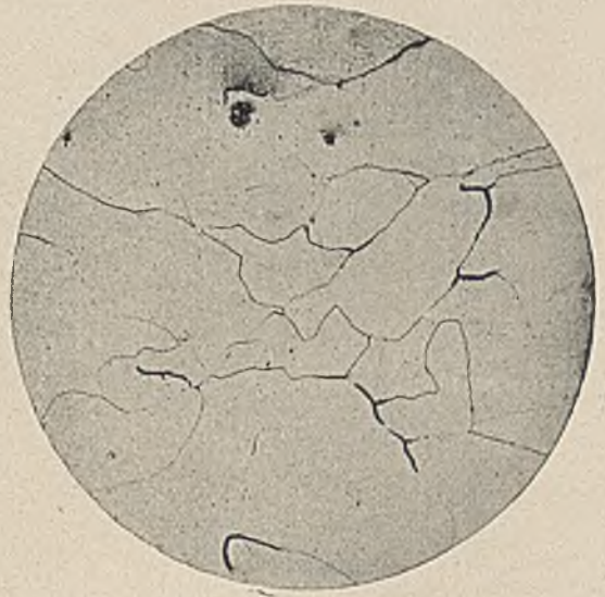
Abbildung 10. Probe der Druckstufe II, bei 500° 1 Std. geglüht. × 100
