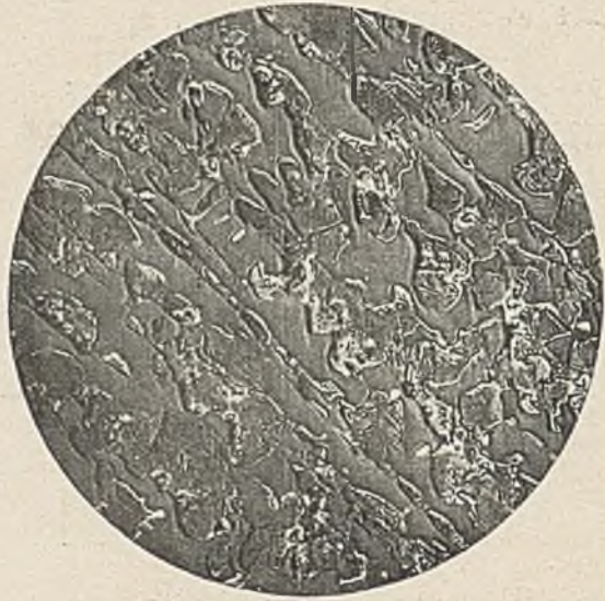
Abbildung 7. HNO 3 -Ätzung, darauf angelassen.
