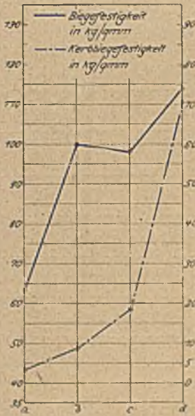
Abbildung 4. Ergebnisse der Prüfung auf Biegefestigkeit (linke Teilung) und Kerbbiegefestigkeit (rechte Teilung). Material 0,6 % C. a = gegossen, b = gewalzt, c = gelocht, d = gezogen.
