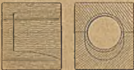
Abbildung 17. Kernkasten für den Haubenkern.
