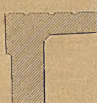
Abbildung 3. Flansch mit eingedrehten Nuten.
