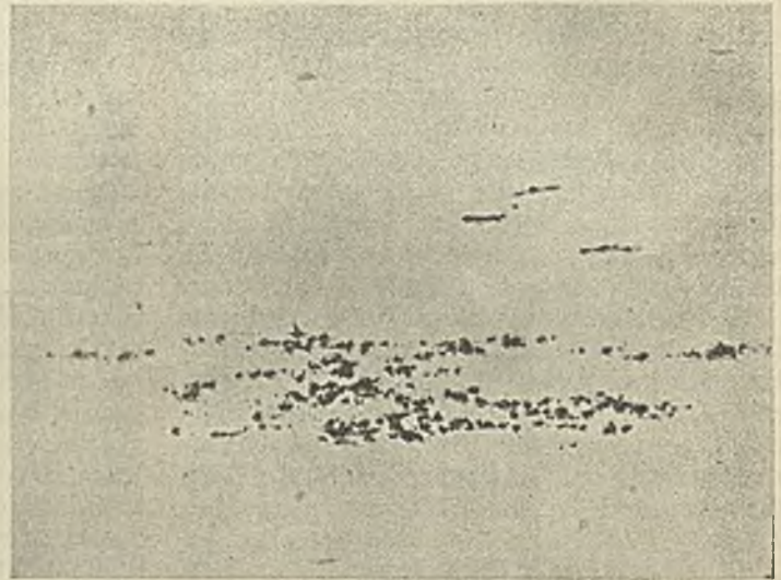
Abbildung 1. Aluminium-Einschlüsse in einem Stahlstück.
