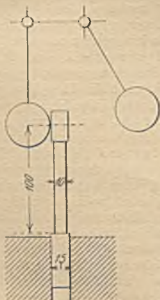
Abbildung 11. Maschine von Gustafsson. Anordnung der Schlaggewichte.
