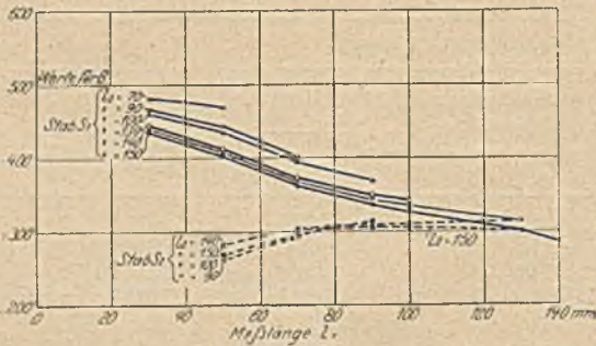
Abbildung 12. Veränderlichkeit der Größen A und B in der Gleichung \delta_1 = A + \frac{B}{\sqrt{l}} bei demselben Stabe mit der Größe der beiden zur Berechnung benutzten Meßlängen l_1 und l_2 .
