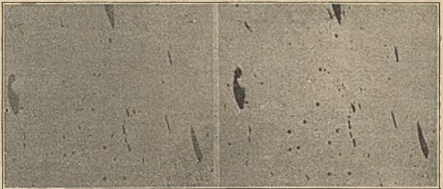
Abbildung 1 und 2. Sulfideinschlüsse. Ungeätzt. Mit Natriumpikrat geätzt.
