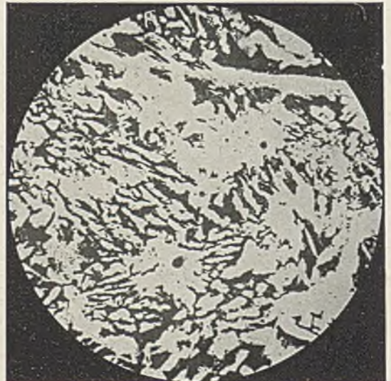
Abbildung 15. Gefüge eines vorzeitig gebrochenen Zahnrades.
