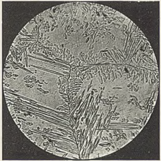
Abbildung 2. Drei aneinanderstoßende Ferritkörner mit nadelartigen Aetzfiguren.
