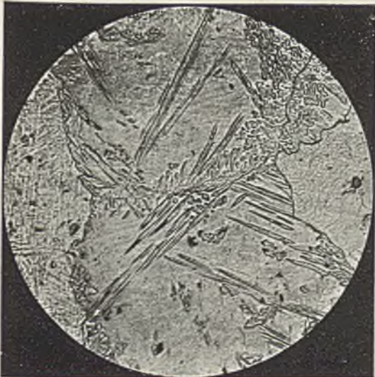
Abbildung 3. Ferritkörner, teils wenig, teils stark aufgeraut.
