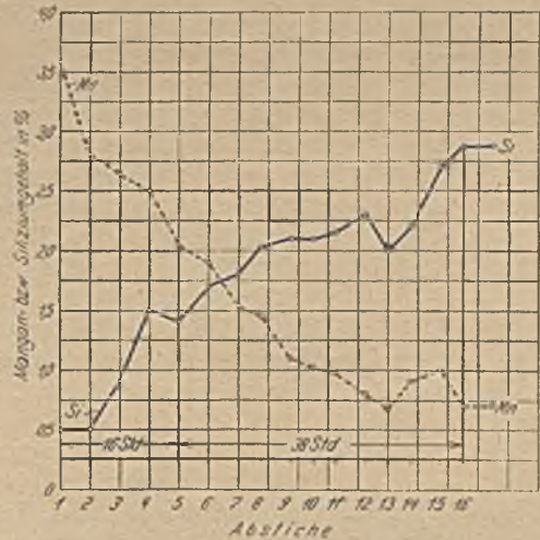
Abbildung 6. Umsetzen von Stahleisen auf Hämatit.
