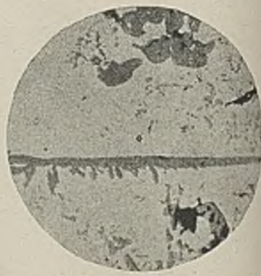
Abbildung 5. I. V. \times 200 Zinkoxyd-Einschlüsse in Messing; ungeätzt.
