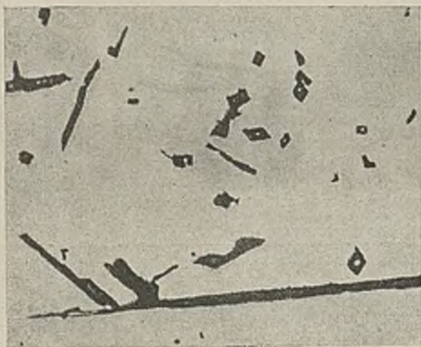
Abbildung 3. I. V. \times 200 Große Zinkoxyd-Einschlüsse in Bronze, die in Sand gegossen wurde; ungeätzt.
