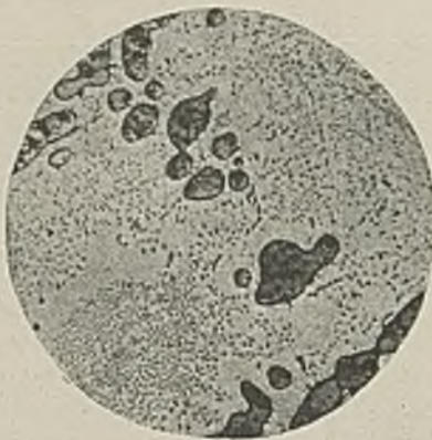
Abbildung 2. I. V. \times 200 Kupferoxydulkristalle und Eutektikum Cu-Cu 2 O; ungeätzt.
