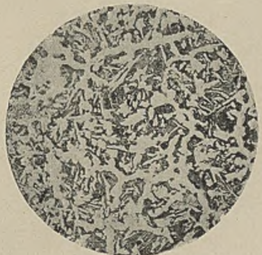
Abbildung 28. × 120 Abgefangene Schmelzung ohne Desoxydationsmittel. (0,38 % C, 0,06 % Si, 0,02 % Mn.)
