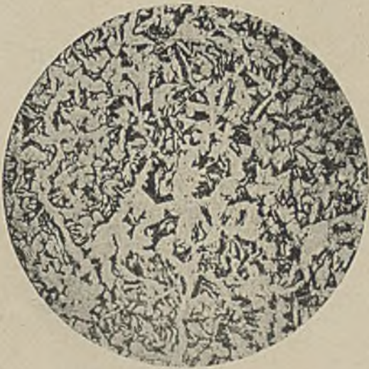
Abbildung 29. × 120 Abgefangene Schmelzung ohne Desoxydationsmittel.
