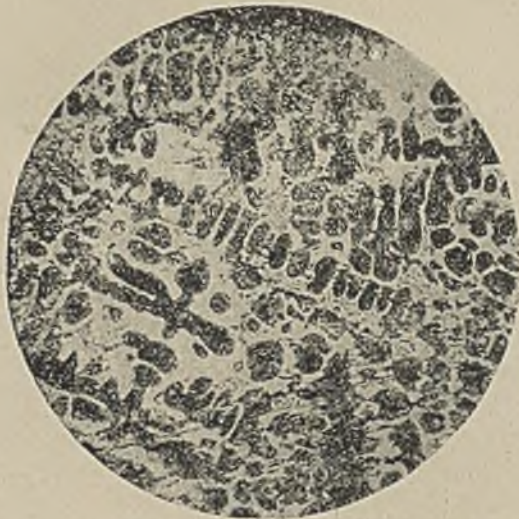
Abbildung 27. × 120 Bis zur Zündung geblasenes Roheisen. (2,95 % C, 0,89 % Si, 0,07 % Mn.)
