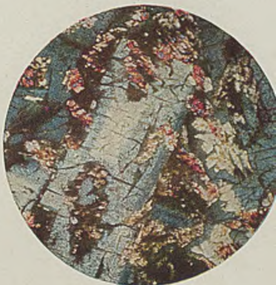
Abbildung 17. Naturfarbenaufnahme. \times 75 Blau polarisierende beständige Melilithe (Gefügebestandteil Nr. 1) und Melilithe mit höheren Interferenzfarben (gelb-rot) (Nr. 2).
