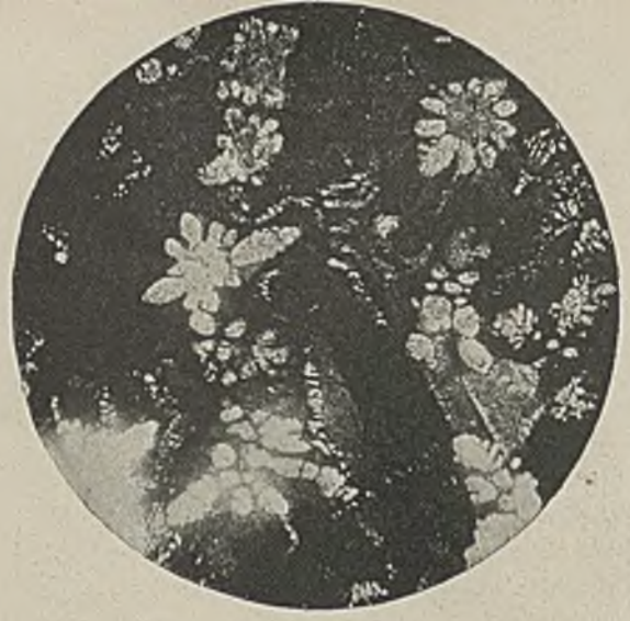
Abbildung 11. × 75 Synth. Thomasrohelschlacke A 0 , zerfallend. Gelbe Stern- förmige Neubildungen in blauen Meliliten. Pol. Licht.
