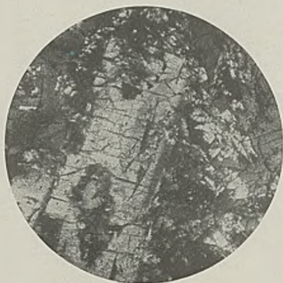
Abbildung 16. Schwarz-weiß Aufnahme \times 75 von der beständigen Stückschlacke RSt, im polarisierten Licht.
