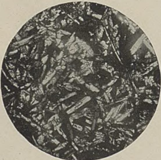
Abbildung 14. × 75 Synth. Thomasrohelschlacke B, Fe, Mn, beständig. Feine
