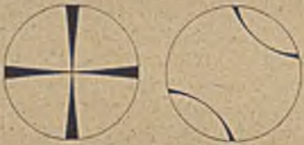
Abb. 3. Achsenbilder eines einachsigen und zweiachsigen Kristalls.
