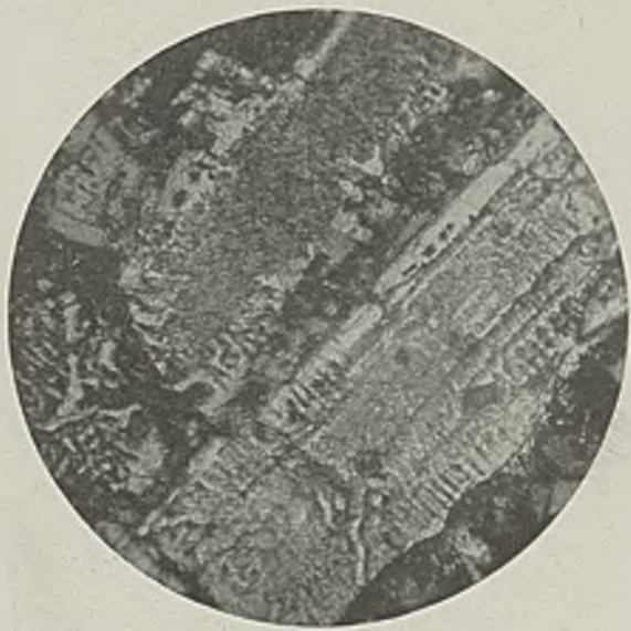
Abbildung 18. Schwarz-weiß Aufnahme \times 75 der zerfallenden Stückschlacke Phra im polarisierten Licht.
