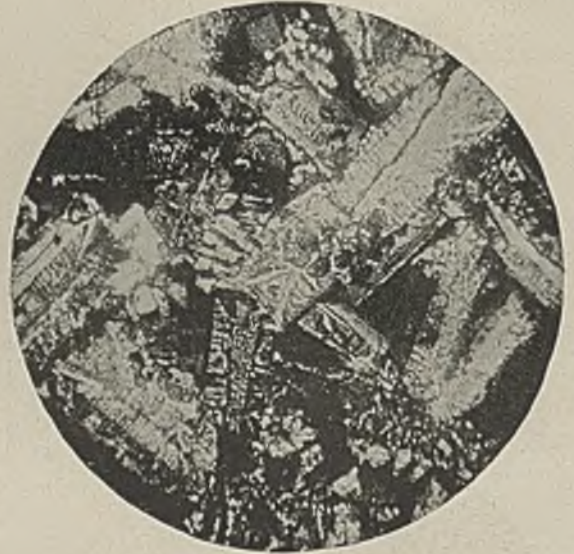
Abbildung 13. × 75 Synth. Thomasrohelschlacke B 0 , zerfallend. Kennzeichnend zerfallende Melilithe. Gefügebestandteil Nr. 8 (vergl. Tafel 2, Abb. 18/19). Pol. Licht.
