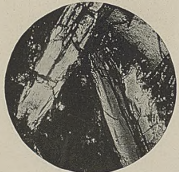
Abbildung 15. × 76 Synth. Thomasrohelschlacke C, Fe, Mn, beständig. Feine
