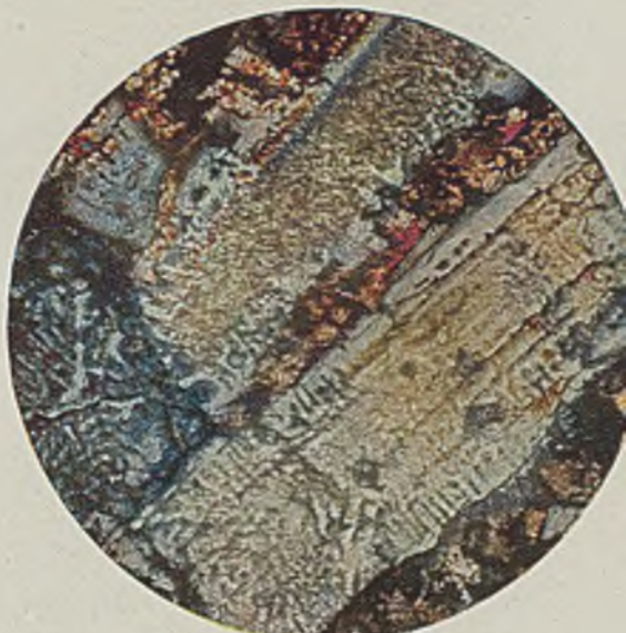
Abbildung 19. Naturfarbenaufnahme. \times 75 Die polarisierenden Melilithe (Abb. 17) sind im Inneren völlig umgelagert in andere Gefügebestandteile von höherer Licht- und Doppelbrechung.
