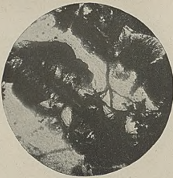
Abbildung 10. × 75 Farrenkrautähnliche Mangan- und Eisensulfidglobulle in beständigen Meliliten. Wl 4 pol. Licht.
