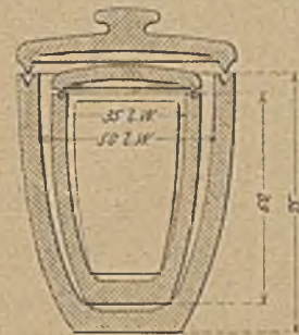
Abb. 20. Platintiegel in Porzellanschutztiegeln.
