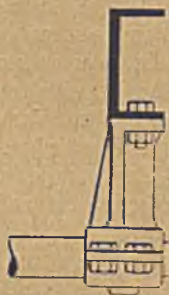
Abbildung 6. Mangelhafte Lager- befestigung.
