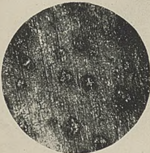
Abbildung 3. \times 100 Acht Stunden dem Leitungswasser ausgesetzt.
