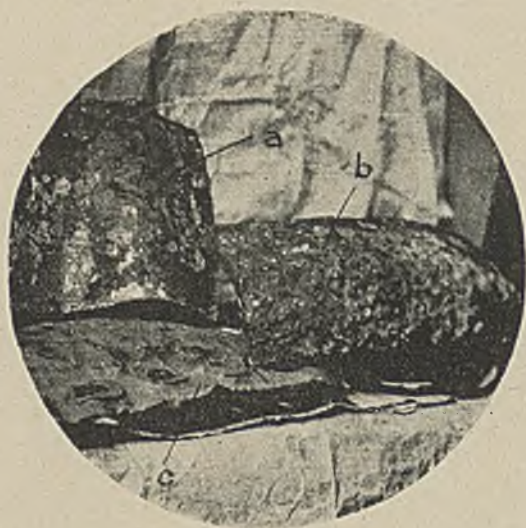
Abbildung 6. Kesselausschnitte eines Dampfkessels, der mit Wasser entsprechend Abb. 5 betrieben wurde.
