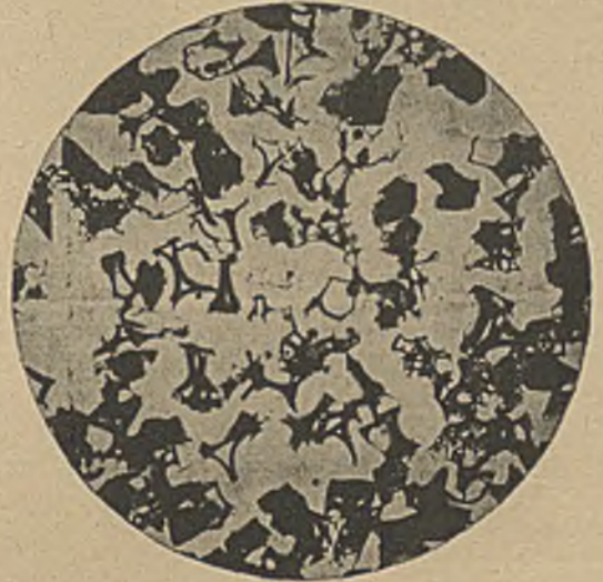
Abbildung 1. Thermosit, gepulvert, unter dem Mikroskop. Schol hat sich dafür das Wort „Thermosit“ schützen lassen.
