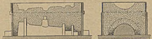
Abbildung 25. Zum Pressen vorbereitete Sandform.
