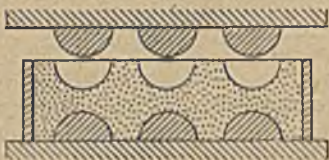
Abbildung 31. Sandverdichtung bei Stapelguß.
