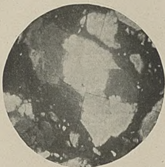
Abbildung 5. Silikastein aus kristallinem Quarzit.
