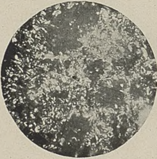
Abbildung 4. In Tridymit umgewandelter Quarz eines Silikasteines.
