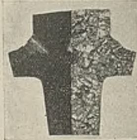
Abbildung 39 und 40. Schliffbild und Spalt- und Sprengprobe.
