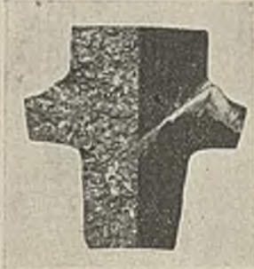
Abbildung 37 und 38. Schliffbild und Spalt- und Sprengprobe.
