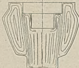
Abb. 30. Prüfversuch mit der Legierung 95% Zn, 1% Sn, 4% Al.
