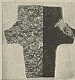
Abbildung 31 und 32. Schliffbild und Spalt- und Sprengprobe.
