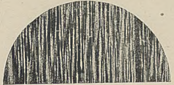
Abbildung 2. × 4 Wie Abb. 1, jedoch Querschliff auf P geätzt.
