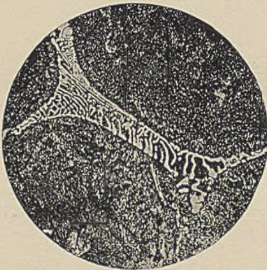
Abbildung 11. × 400 Kristallseigerung im Wolframstahl mit 0,7 % C und 3 % W.
