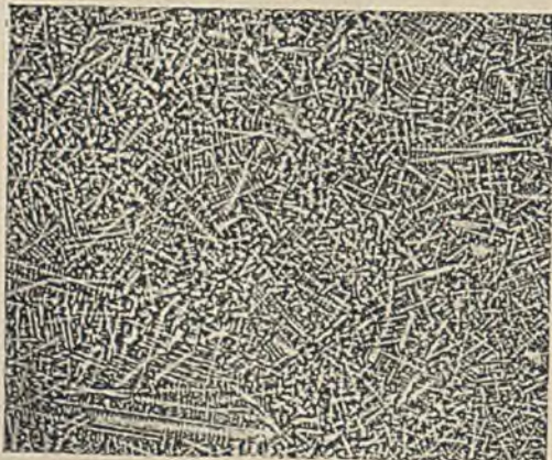
Abbildung 13. × 2 Kristallseigerung in hartem Stahl (Dendriten).
