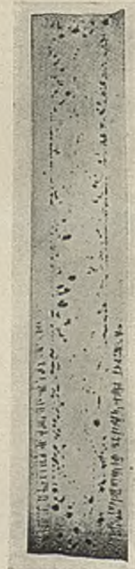
Abbildung 20. Verlorener Kopf eines Stahlgußstückes mit Dendriten.
