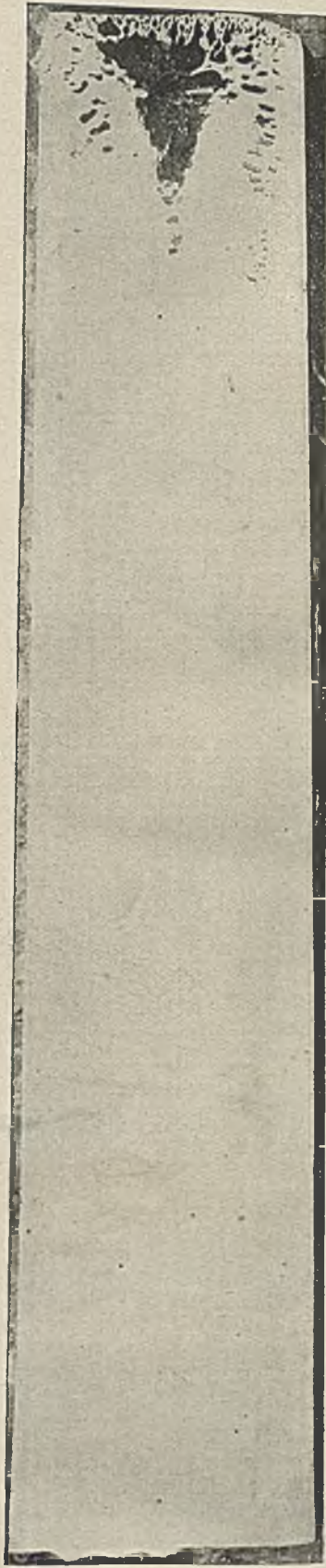
Abbildung 18. Stahlblock mit Lunker. \times \frac{1}{6}
