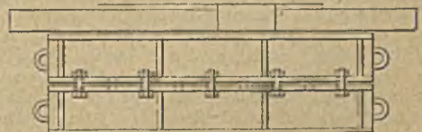
Abbildung 30. Gußbereite, fertig verschraubte und beschwerte Form.
