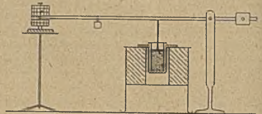
Abbildung 1. Einrichtung zur Feststellung der Blähung von Kokskohle.
