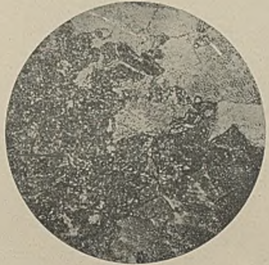
Abbildung 9b. \times 500 Draht aus Chrom-Kohlenstoff-Legierung; Randpartie.
