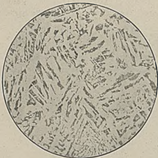
Abbildung 2. \times 100 Material im angelieferten, berhitzten Zustande.
