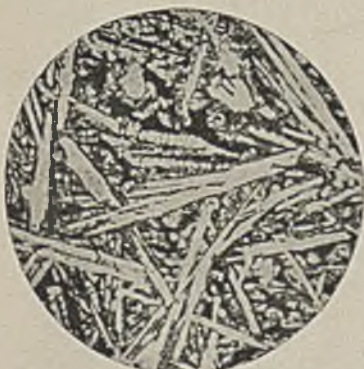
Abbildung 4. \times 35 Tridymit in Fayalit als Grundmasse vor dem Polleren.
