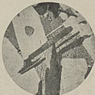
Abbildung 5. \times 425 Tridymit (dunkel) und Fayalit (hell) nach dem Polleren.
