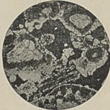
Abbildung 13. × 35 Garnister und Sand in fayalithaltiger Schlacke im unteren Herdteil.
