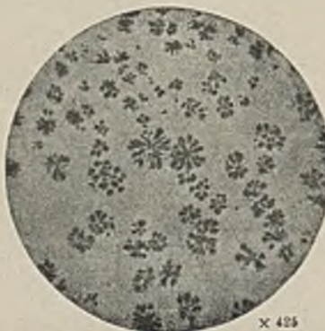
Abbildung 13. × 35 Garnister und Sand in fayalithaltiger Schlacke im unteren Herdteil.
