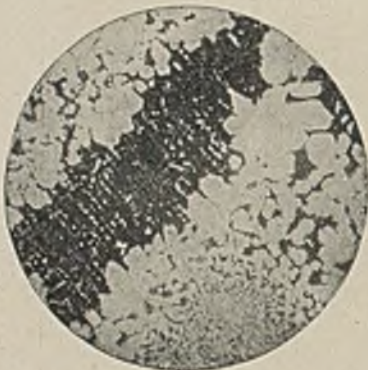
Abbildung 9. × 35 Herdmasse; Kristoballit mit Magnetit.
