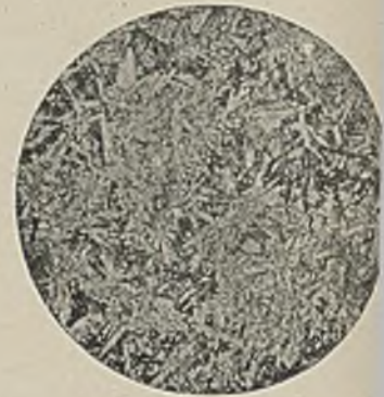
Abbildung 11. × 35 Vollständige Umwandlung einer alten Herdstelle in Tridymit.
