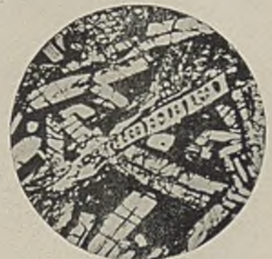
Abbildung 6. \times 35 Saure Schlacke. Kristobalit in Rhodochrosit als Grundmasse.
