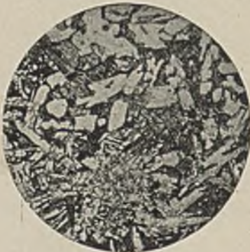
Abbildung 12. × 35 Uebergang von Tridymit in Kristoballit an der Herdoberfläche.
