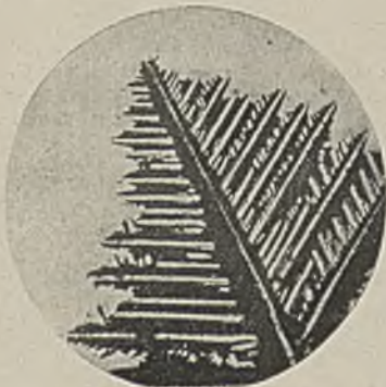
Abbildung 2. \times 18 Dendritischer Kristobalit mit eingelagerter Schlacke.
