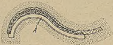
Abbildung 12. In den Boden gebettetes Modell eines gebogenen Kielstückes mit Aushebung A für die Kernstücke.
