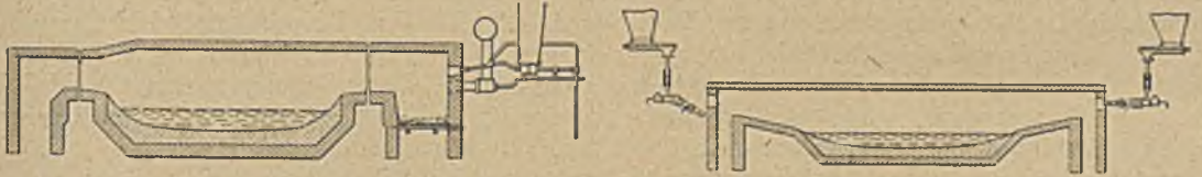
Abbildung 13 und 14. Anordnung des Brenners an Herdschmelzöfen.
