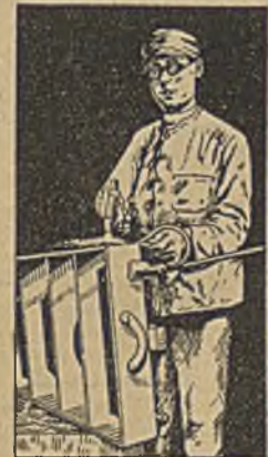
Abbildung 2. Schweißen eines gebrochenen Formkastens. (Zusammenhalten der Bruchstellen mit einer verstellbaren Klammer.)
