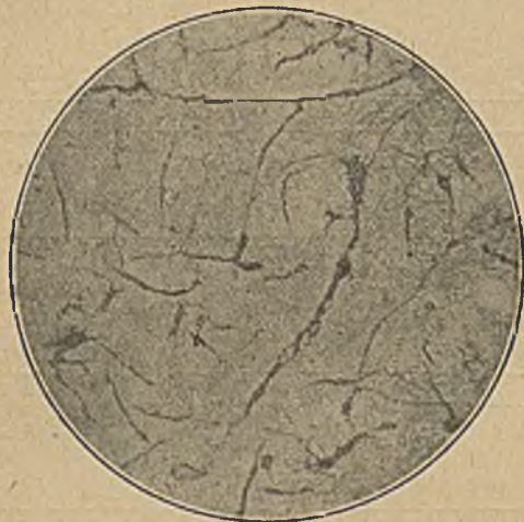
Abbildung 2. × 150 Schmelze mit 3 % Nickel, geätzt mit 3prozentiger Salzsäure in äth. Alk.
