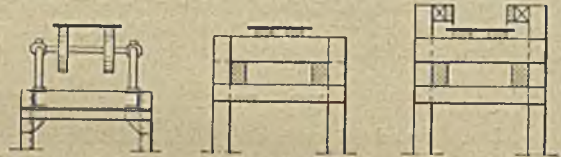
Abbildungen 3 bis 5. Führungen des Stahlband-Gürtelförderers.
