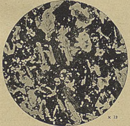
Abbildung 2. Dünnschliff eines Brauneisenerzes aus dem Dogger des Schweizer Jura.
