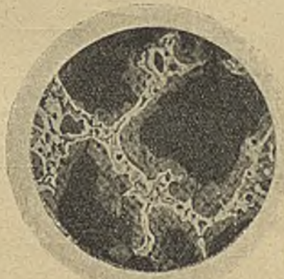
Abbildung 1, \times 250 Gefüge einer Bronze mit 84,5 % Cu, 12,5 % Sn und 3,0 % Pb. 5 sek. in einer 10prozentigen Natriumsulfidlösung geätzt.
