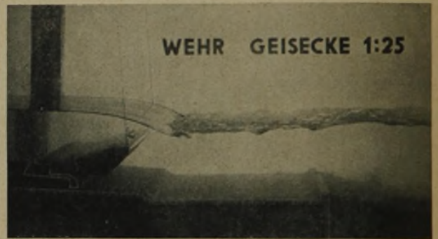
Abb. 9: Abfluß über ein Klappenwehr. Infolge des getauchten Strahles tritt keine Verlandung unterhalb des Wehres ein.
