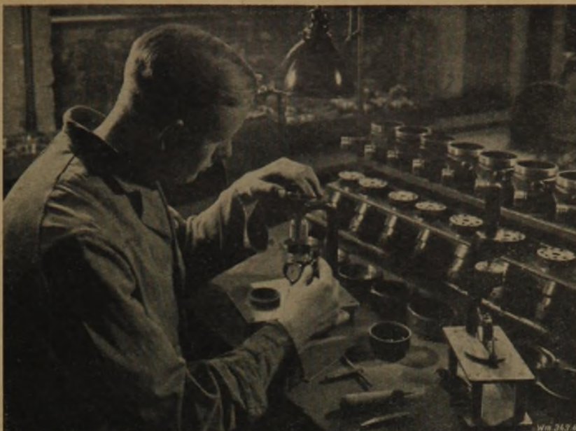
Prüfung von Wassermesser-Einzelteilen auf Maßhaltigkeit. Die Genauigkeit, mit der die in der Fabrikation benutzten Meßinstrumente messen müssen, ist genormt Werkfoto
