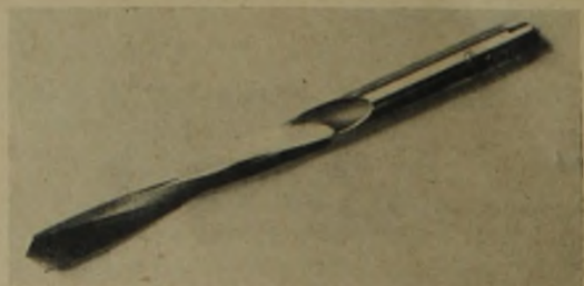
Abb. 7: Spiralbohrer für Magnesiumlegierungen
