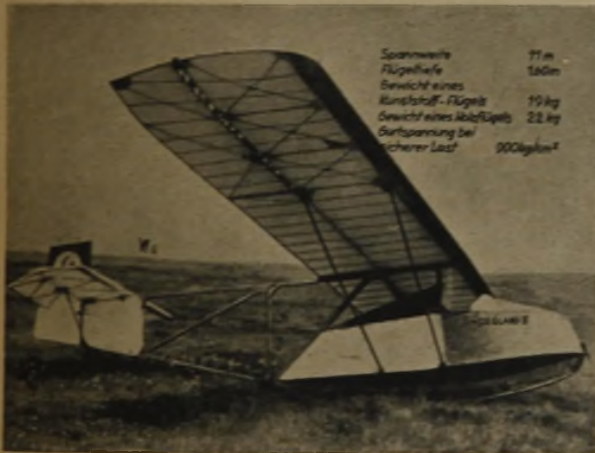
Abb. 26: Segelflugzeug „Zögling“, aus Schichtstoffen (Holzbauweise)
