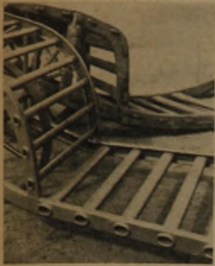
Abb. 14: Stahlschiebkarre aus elliptischen Rohren und Blechprofilen
