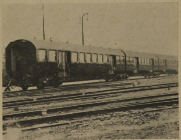
Abb. 2: Großraum-Leichtmetallwagen, erbaut von Linke-Hoffmann-Werke, Leichtmetallausführung
