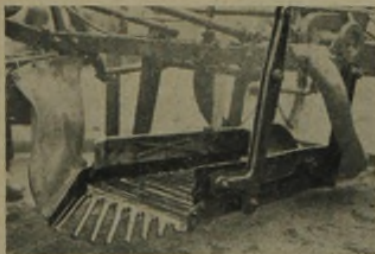
Abb. 19: Kartoffelerntemaschine mit gepreßten Stahlblechteilen
