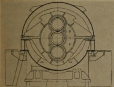
Abb. 22: Querschnitt des Kammwalzgerüsts der 500er-Straße
