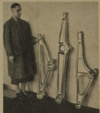
Abb. 18: Motorträger aus Elektron (geschmiedet)
