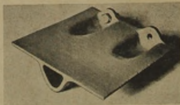
Abb. 14: Formgepreßtes Versuchsstück mit Hohlrippe und Anschlußflanschen
