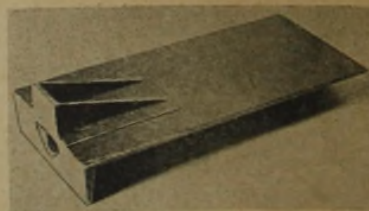
Abb. 15: Formgepreßtes Versuchsstück mit Hohlrippe und Anschlußflanschen
